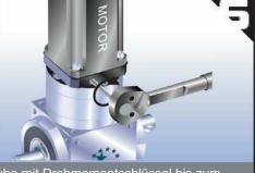
Klemmschraube mit Drehmomentschlüssel bis zum vorgeschriebenen Drehmoment anziehen (siehe Tabelle 2)
