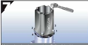
Motorschrauben in angezeigter Reihenfolge bis zum vorgeschriebenen Drehmoment anziehen (siehe Tabelle 1)
