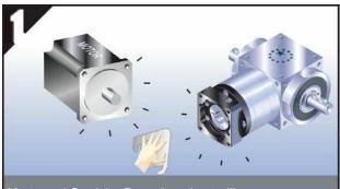
Motor und Getriebe Baugrösse kontrollieren. Planflächen und Motorwelle fettfrei reinigen.
