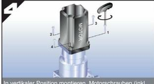
In vertikaler Position montieren. Motorschrauben (inkl. Sicherungsringen) in angezeigter Reihenfolge anziehen bis 5 % vom vorgeschriebenen Drehmoment (Tabelle 1).
