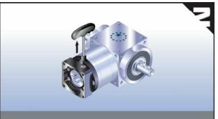
Abdeckschraube entfernen und Klemmschraube richtig justieren
