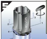
In vertikaler Position montieren. Motorschrauben (inkl. Sicherungsringen) in angezeigter Reihenfolge anziehen bis 5 % vom vorgeschriebenen Drehmoment (Tabelle 1)
